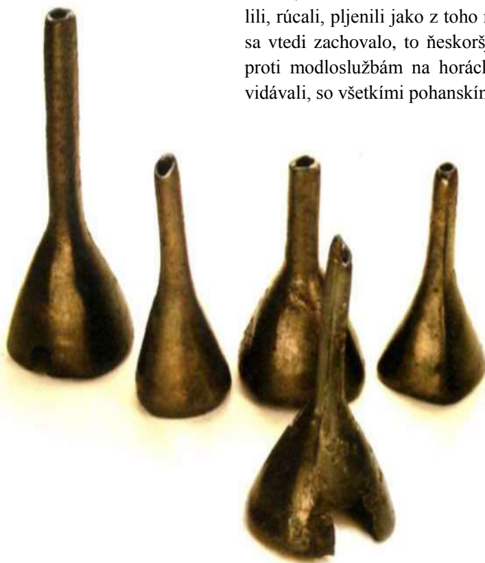
Záhadné predmety, „trubky“, ktoré Božena Němcová považovala za „ozdoby prilbic vojenských“, sú v skutočnosti nákončia kováčskeho mechu. Aj z obrázka vidno, že ich konce sú poznačené ohňom (nálezisko Hodejov)
